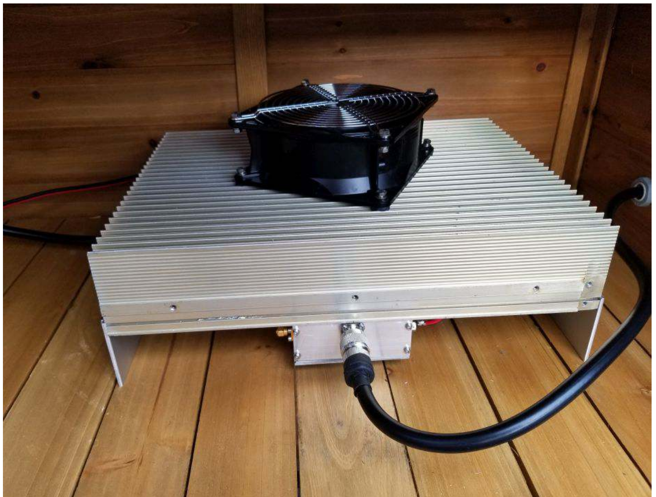
250 Watt 13cm Power Amplifier für QO-100 (DATV)
