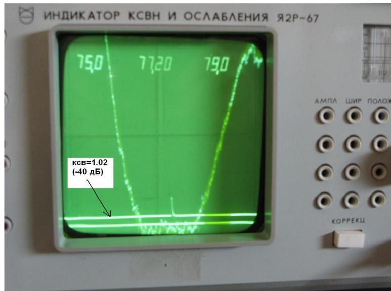
*Рисунок 13: Измеренный КСВ рупора с переходом в волноводном тракте*
