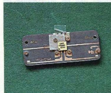
**Bild 8:** Der Endstufen-IC an seinem endgültigen Platz
