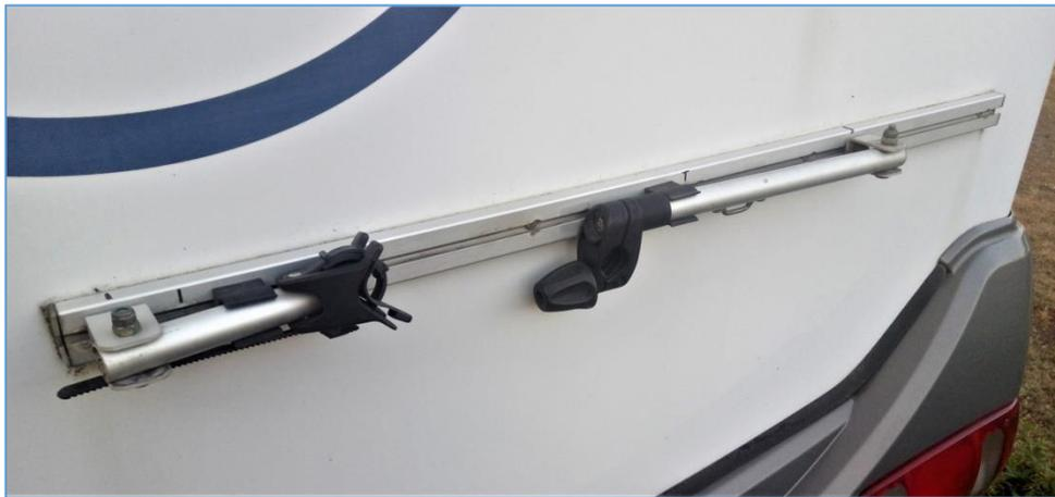
*Die wieder montierten Befestigungsstreben (eingeklappt)*
