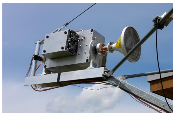
Obr. 16. SSPA, LNA a WR75 přepínač v ohnisku.
