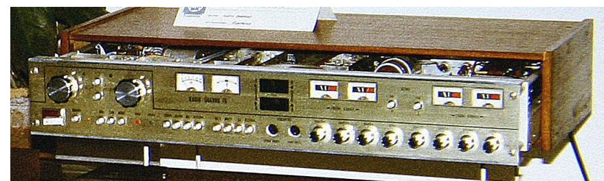
- 14 - Ještě něco z nf. techniky. Malý stereo zesilovač 2x 15W a Quadro přijímač pro normy OIRT a CCIR se zesilovačem 4x 25W (70 léta)
