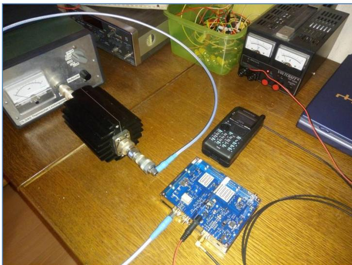
*Überprüfung der Ausgangsleistung des neu erworbenen LZ5HP 13 cm Transverters kurz nach der Lieferung im April*
