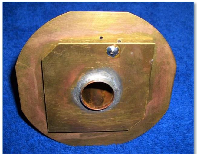
*Das Kabel kennen wir ja bereits. Der Patch Feed und unterstützende Mechanik*
