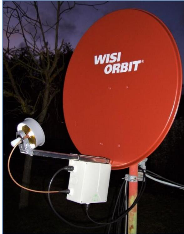
*Die fertig montierte Uplink Einheit*
