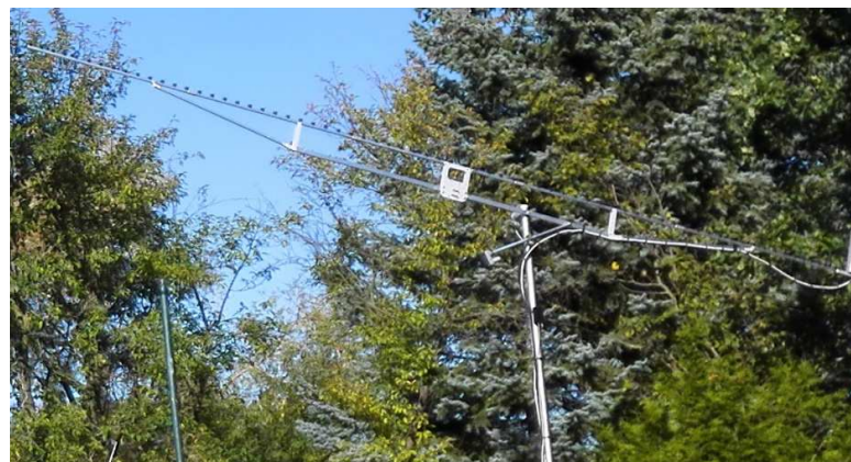
DL1DWI 70 el yagi used on 1296 EME
