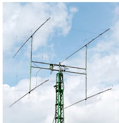
2m EME anténa 4x 2M5WL, kterou na Solnici používá Martin OK1UGA a Slávek OK1CU
