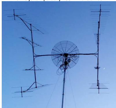
Zajímavá konfigurace antén u Marka, SP1JNY ve Štětíně pro EME na 144/432/1296/2320 MHz
