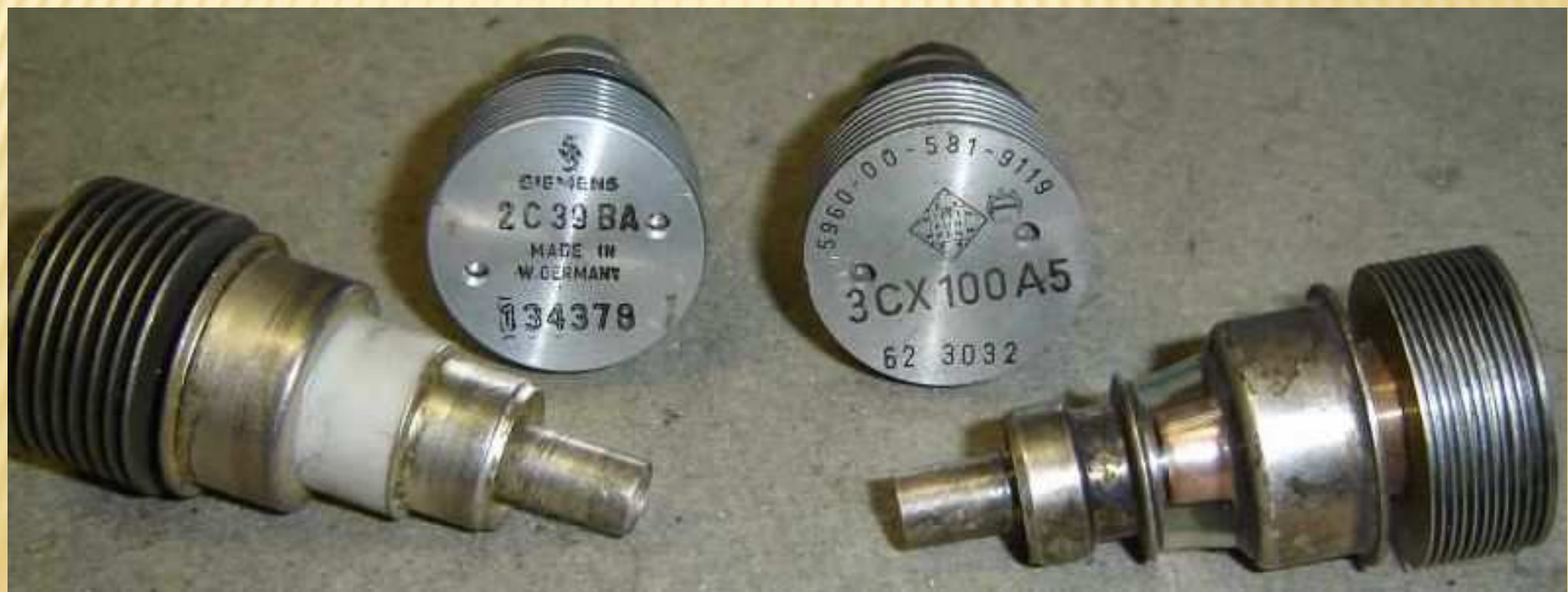
Elektronkový směšovač a zesilovač rok 1973
