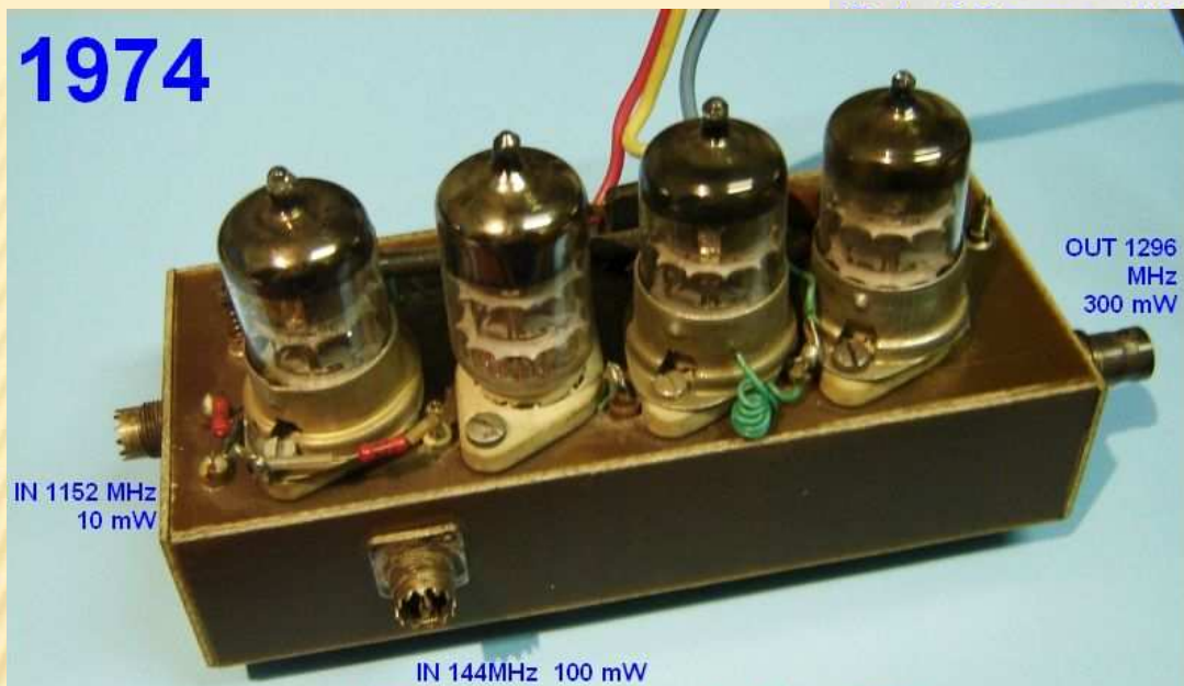
Elektronkový směšovač a zesilovač rok 1973
