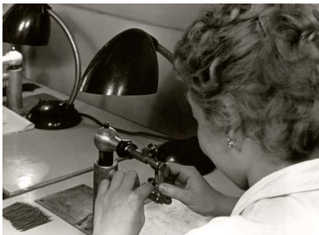
Bodové svařování přívodů elektrodového systému
