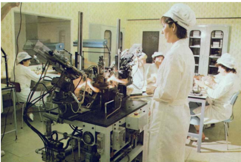
Montáž elektronové soustavy – fixace elektronové optiky
