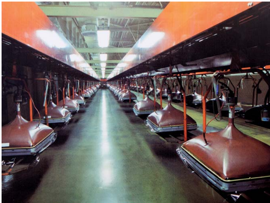
Finální fyzikální operace na obrazovce (vysokonapěťové vyjiskřování a aktivace katod)
