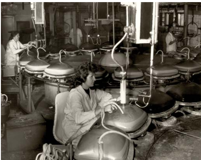
Vytváření stínítkové vrstvy obrazovky
