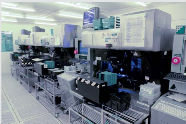
Fotolitografická linka – srdce výroby integrovaných obvodů
