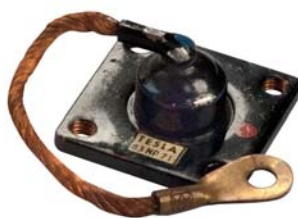
Germaniová usměrňovací dioda pro proud až 20 A
