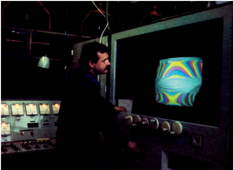
Měření optických a elektrických parametrů obrazovek
