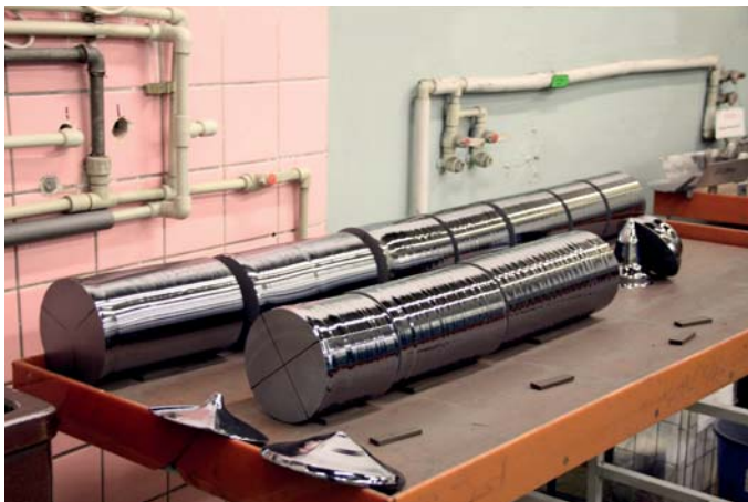
Rozřezaný monokrystal podle dosažených parametrů (specifický odpor)
