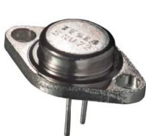
Germaniový výkonový nízkofrekvenční tranzistor pro výkon 4 W
