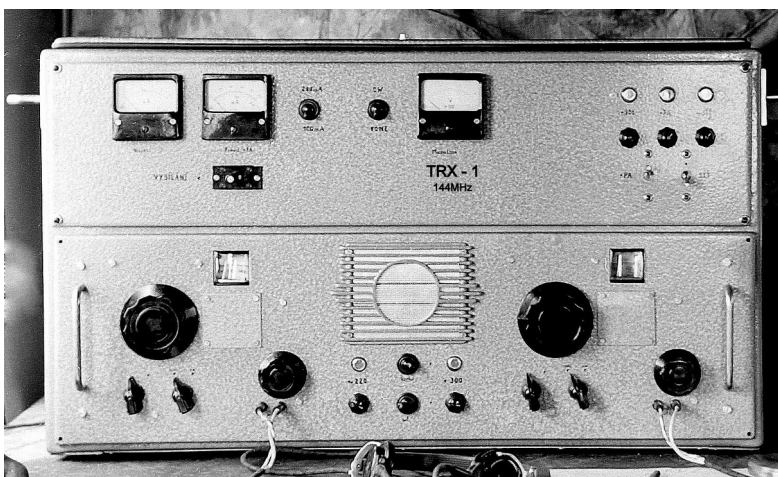
- 1 - Léta šedesátá, AM- TRX 144MHz pro dva operátory . TX – řízený X-talem, později laděný. Používaný v závodech stanicí OK2KEZ
