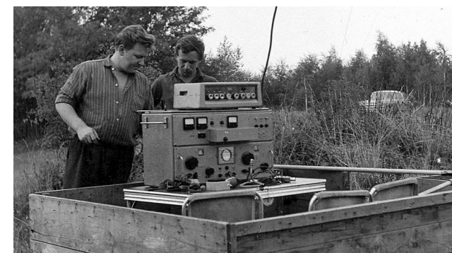
- 1 - Léta šedesátá, AM- TRX 144MHz pro dva operátory . TX – řízený X-talem, později laděný. Používaný v závodech stanicí OK2KEZ
