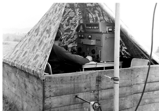
- 1 - Léta šedesátá, AM- TRX 144MHz pro dva operátory . TX – řízený X-talem, později laděný. Používaný v závodech stanicí OK2KEZ
