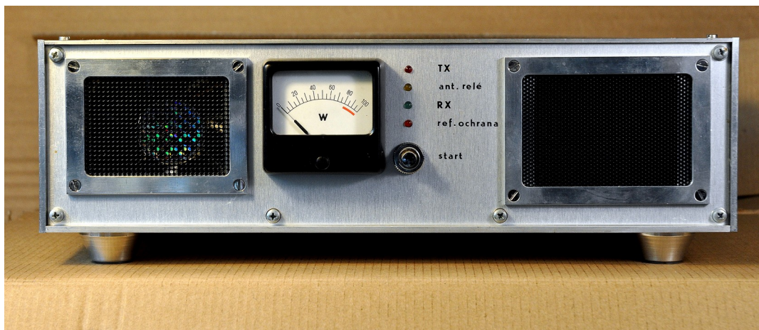
Koncový stupeň 144MHz – 60W s mosfetovým modulem RA60H1371M Na základní desce není namontován nížkošumový předzesilovač s filtrem.
