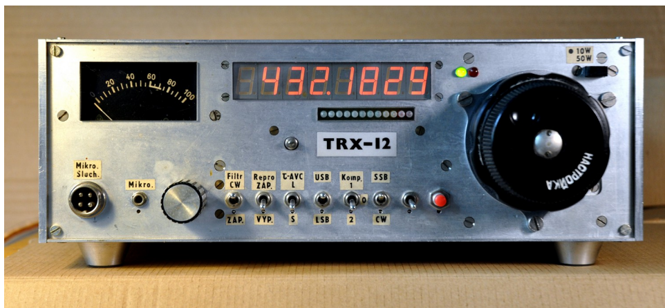
Pohled na čelní panel TRX-12 určený speciálně pro pásmo 432MHz. PA osazen obvodem RD60HUF1 s výstupním výkonem 60W. Obr. vpravo, pohled na konstrukční uspořádání TRXu shora.
