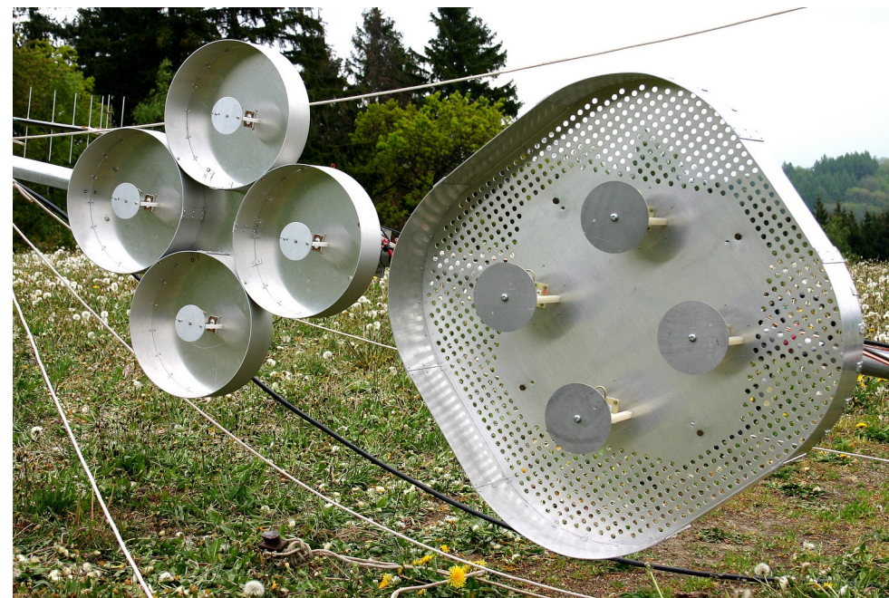
Transvertory pro 1296 a 2300MHz ve spojení se čtyřnásobnými anténami SBF. Jako mf. pro tato pásma je používán TRX-11 (foto již bylo uvedeno).
