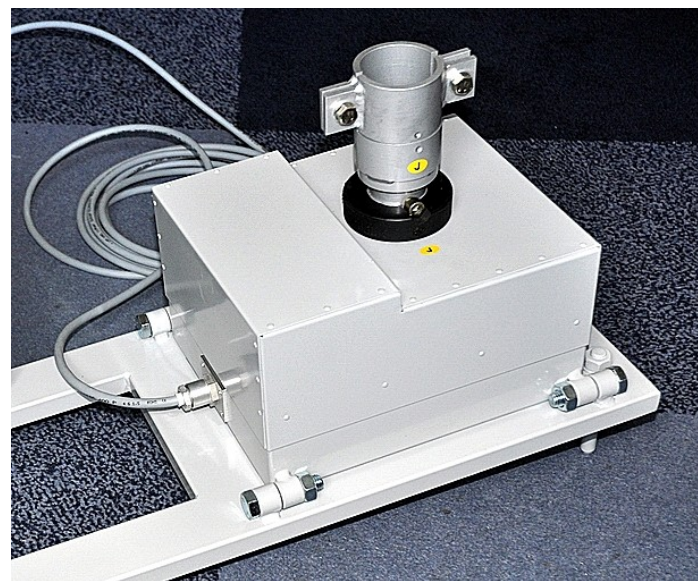
- 12 - Pro otáčení 12m stožáru zhotoven rotátor, na snímku vpravo je PA 30 W pro TRX11. Dále předzesilovače 144/432 MHz a RX- 432MHz.
