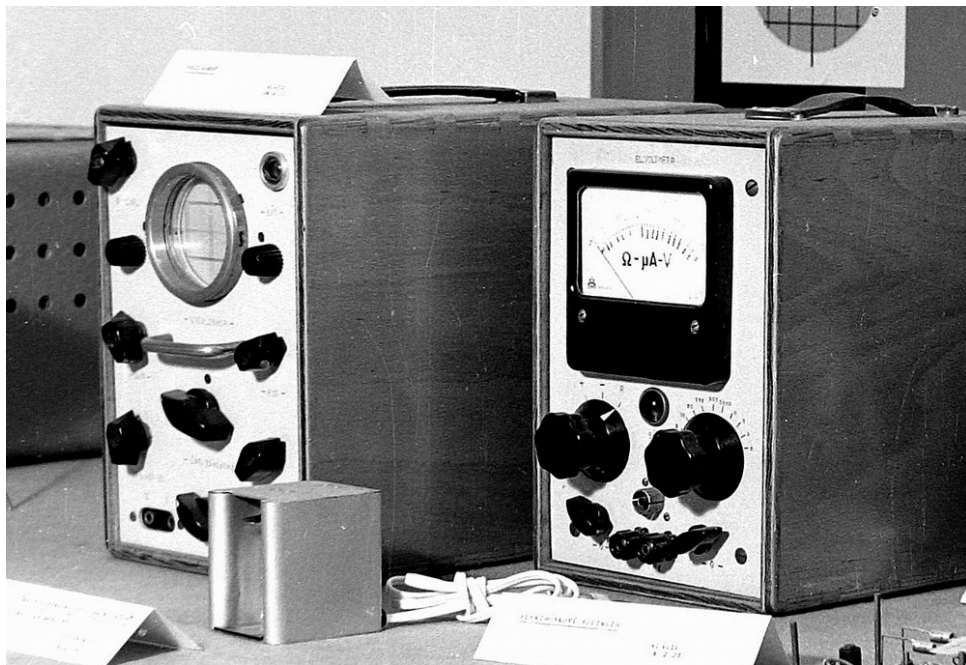
Přístroje pro vybavení dílny z 60tých let. Vlevo- první osciloskop a el.voltmetr, vpravo- na policičce , v pořadí druhý a na stole stole třetí osciloskop.
