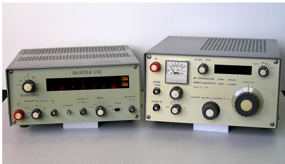
Univerzální čítač kmitočtu a nf. směšovací generátor s dig. Stupnicí.
