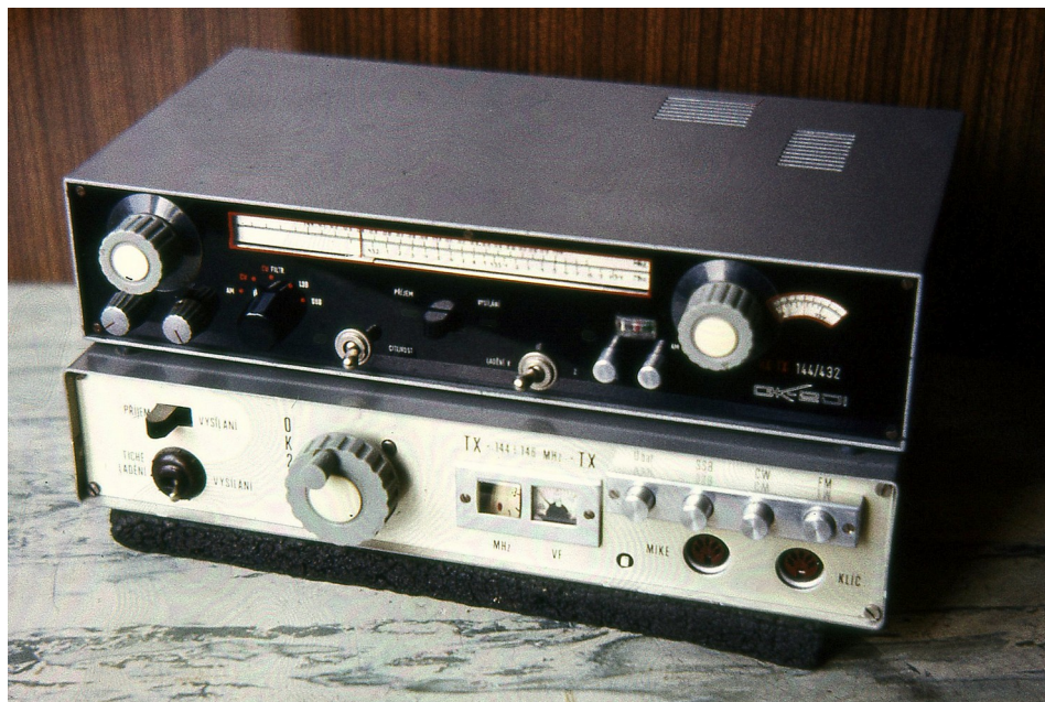
TRX- 144/432MHz pro BBT, dole TX -144MHz -1W (1965)
