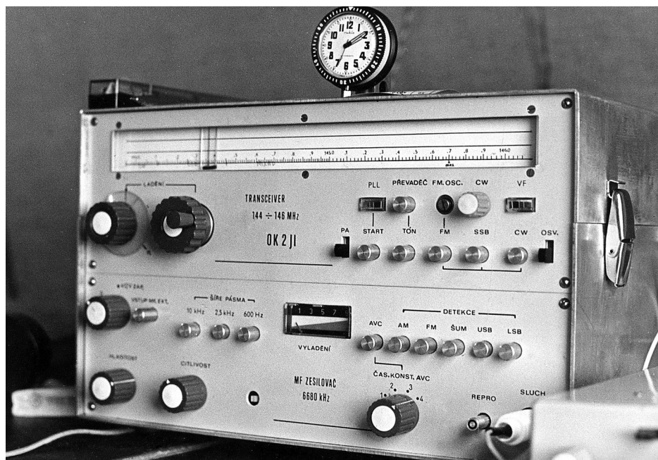
První, větší laditelný SSB TX pro 144MHz používaný pro závody a provoz přes satelit „OSCAR-6“: Zařízení bylo realizováno asi v roce 1971.
