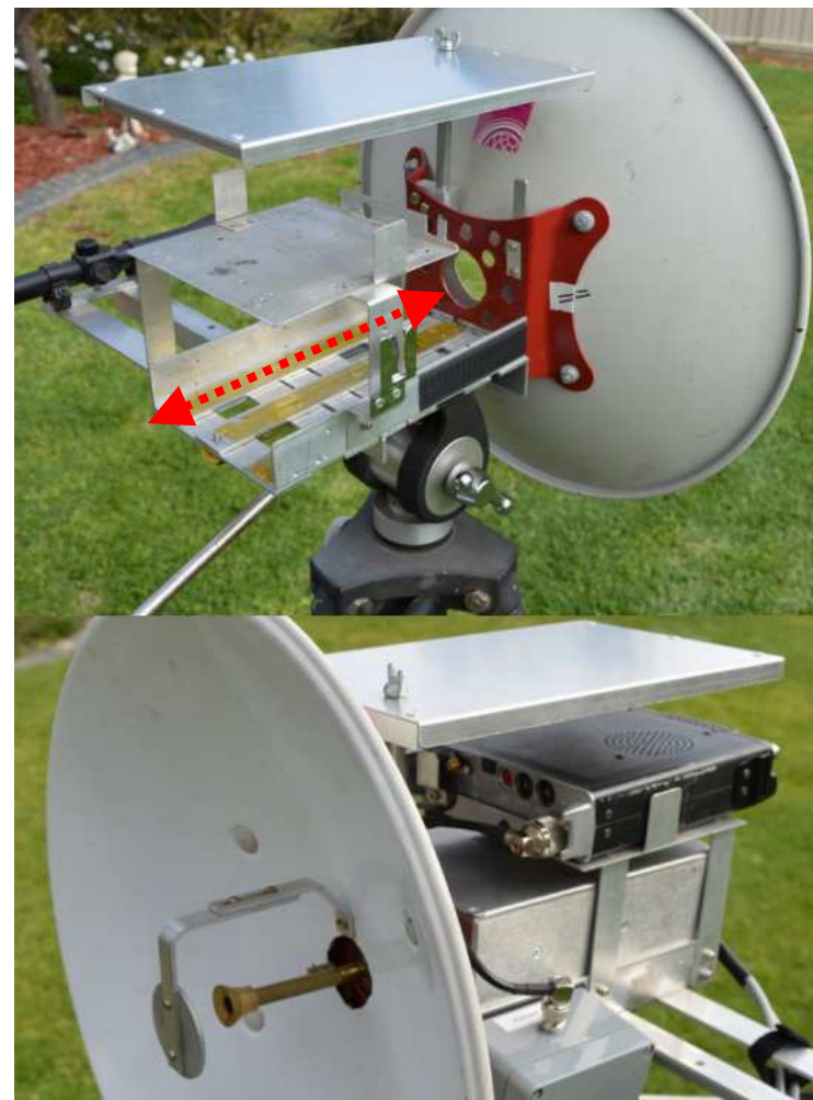
Systém VK5ZD pro snadnou výměnu pásem prostým zasunutím požadovaného transvertoru
