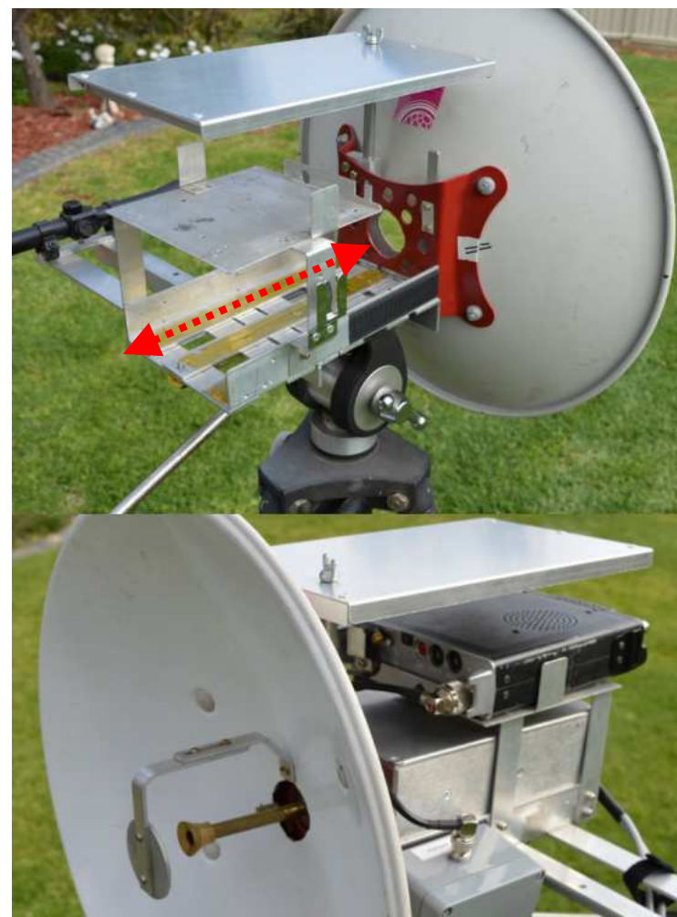
System VK5ZD do łatwej zamiany pasm poprzez proste włożenie pożądanego transwertera
