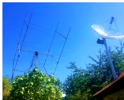
Antény Ivana, OK1IL pro EME na 2m a 23cm.
